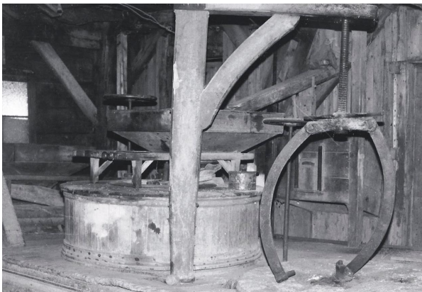
Trémie, jupe de la meule et potence servant à entretenir ou changer les meules.
